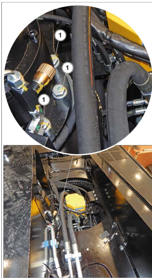
Figura 159: Comprobación de apriete del tornillo de fijación del reductor de rotación
