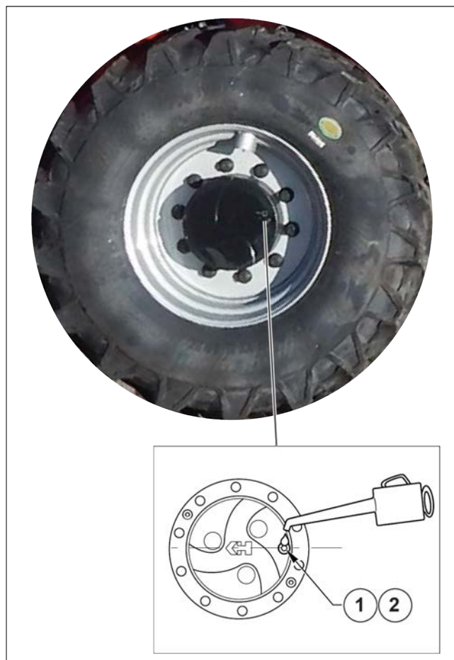
Figura 156: Comprobación del nivel de aceite del reductor de ruedas delanteras y traseras
