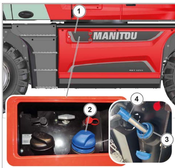
Figura 209: Comprobación y limpieza del filtro de llenado del depósito de DEF
