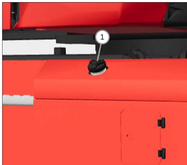
Figura 117: Llenado del depósito de combustible
