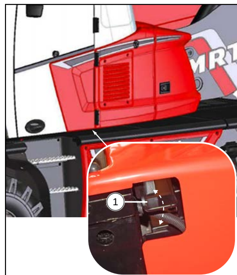
Figura 60: Palanca de liberación de la ventana de la puerta desde el exterior de la cabina
