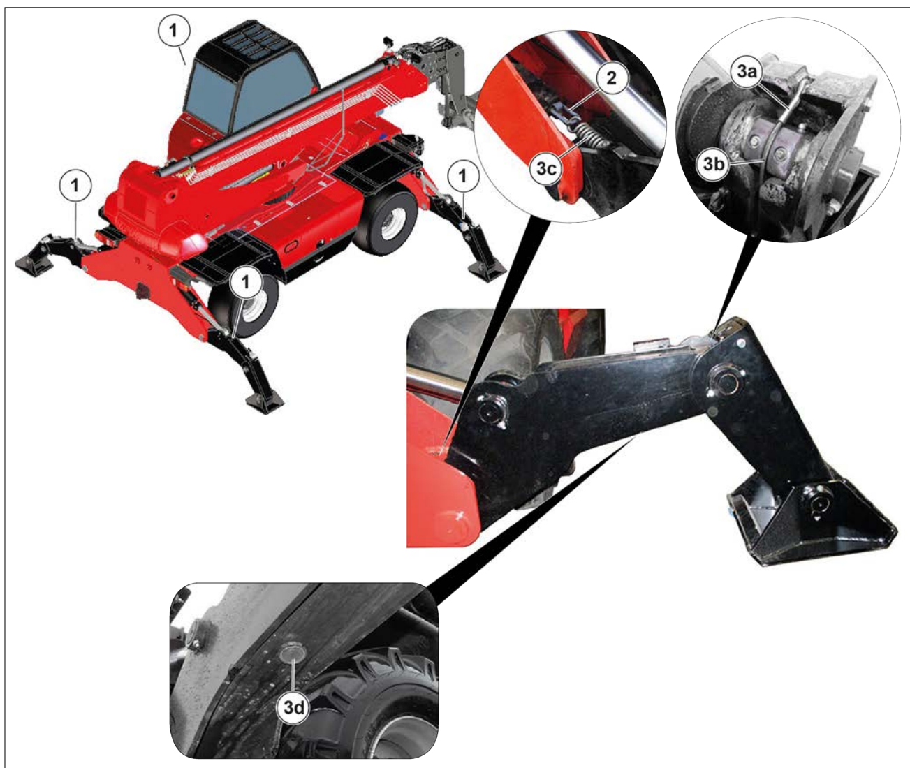
Figura 192: Sustitución de componentes internos de los estabilizadores
