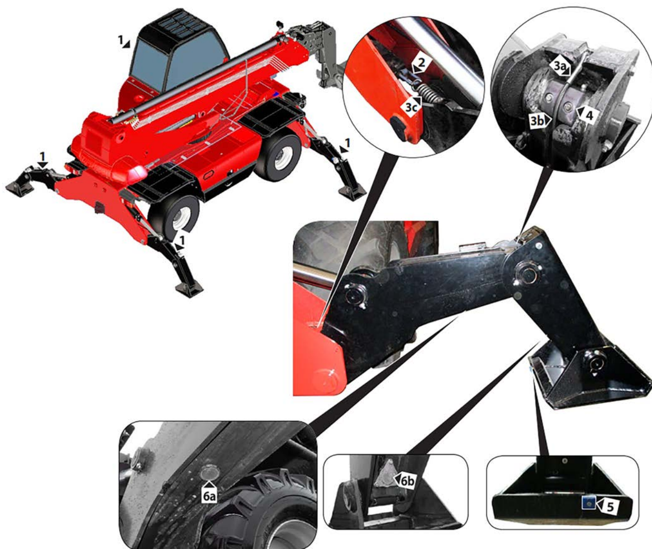
Figura 164: Comprobación del sistema de bajada y subida de los estabilizadores
