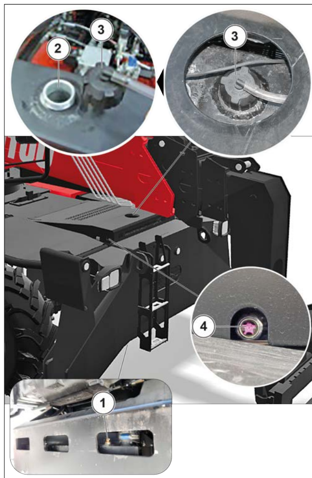
Figura 181: Sustitución del refrigerante
