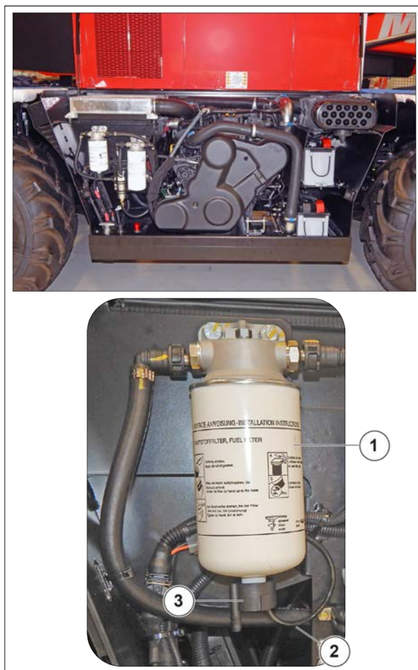
Figura 144: Comprobación del prefiltro de combustible
