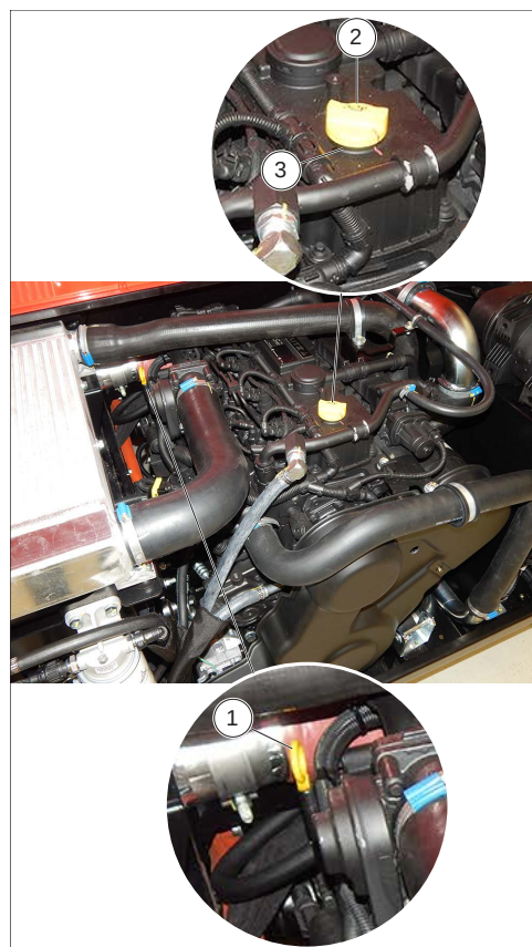
Figura 138: Nivel del aceite del motor
