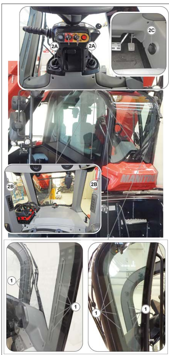
Figura 61: Difusores antivaho y rejillas de aire de calefacción
