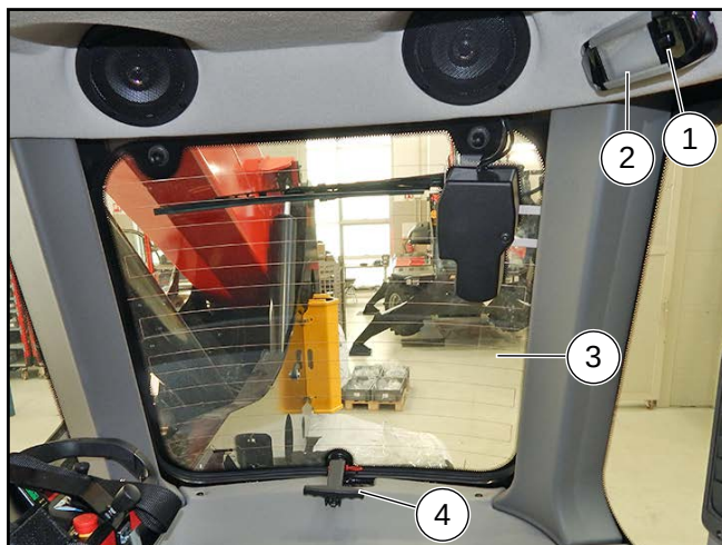
Figura 57: Luz de techo y palanca de apertura de la ventana trasera
