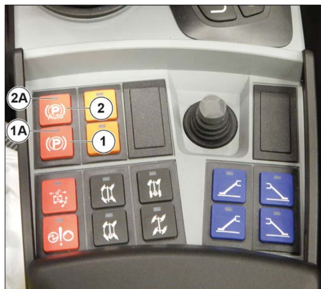
Figura 126: Uso del freno de estacionamiento
