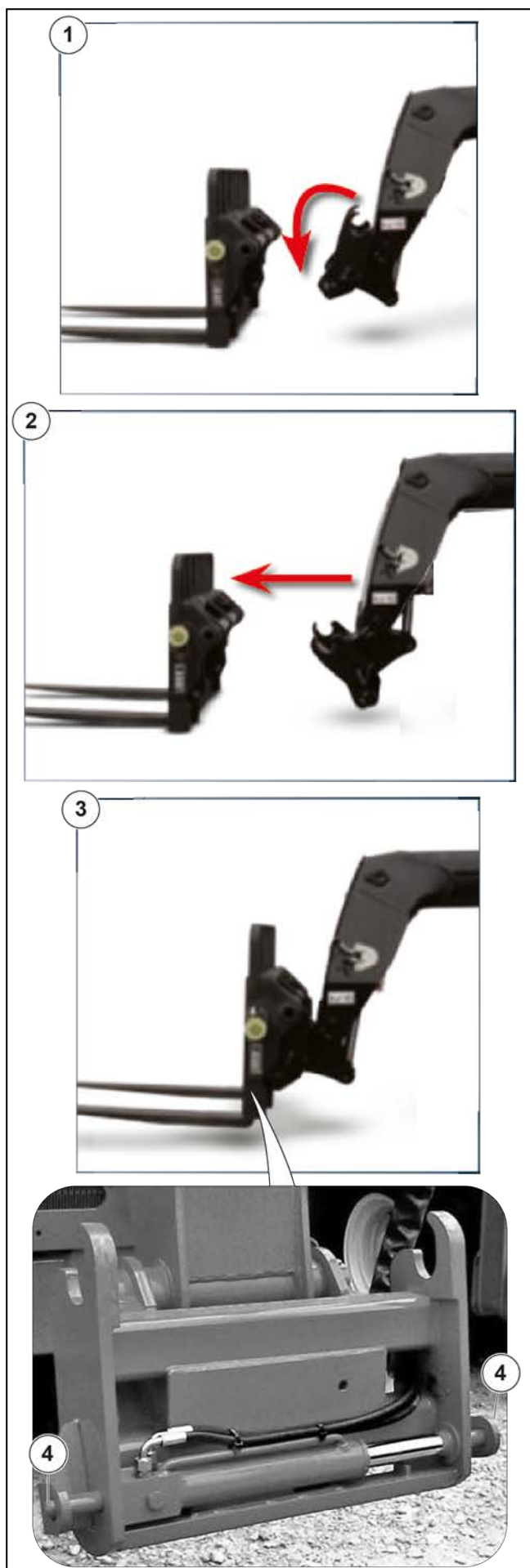
Figura 120: Recolocación del implemento con bloqueo hidráulico
